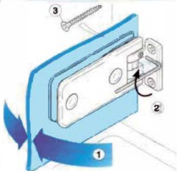
1/ **ajuster et maintenir la porte en position fermée jusqu'au serrage final**
